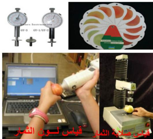
شكل 69: دليل الألوان (أحد وسائل الحكم على مدى تلوين الثمار) وجهاز قياس صلابة ثمار العنب
