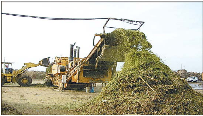
شكل ( 9 ) آلة تقطيع وفرم المخلفات الزراعية
