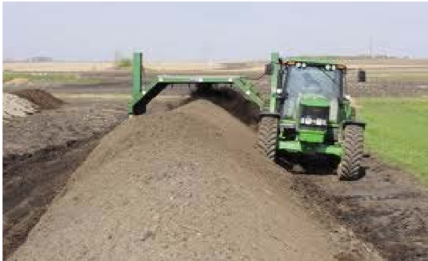
شكل ( 10 ) آلة تسوية الكومة وتغطيتها بالتراب
