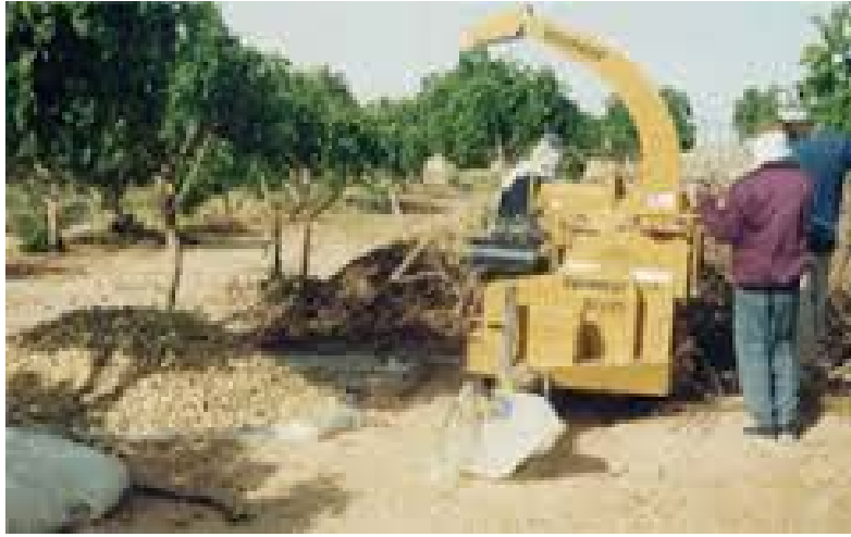
شكل ( 8 ) آلة تقطيع وفرم المخلفات الزراعية
